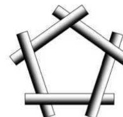
Пятисторонний ПЕНТАГОНАЛЬНЫЙ УЗЕЛ ПЛЕТЕНИЯ, ТРЕБУЮЩИЙСЯ ДЛЯ КОРЗИНОПОДОБНЫХ ПЛЕТЕННЫХ СФЕР
